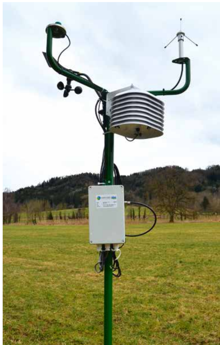
Wetterstation für betriebseigenes Prognosesystem. Bild: Agroscope
